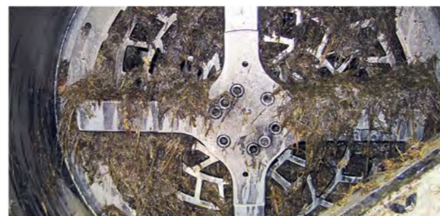
Le rôle du broyeur est de réduire efficacement les substrats et de les débarrasser des corps étrangers.
