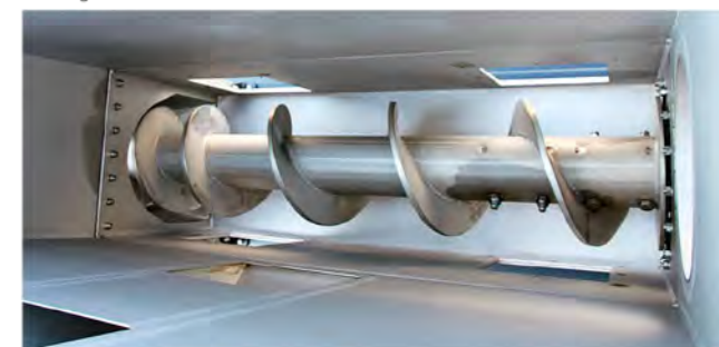
Mélange des substrats solides avec le recirculat déjà en première étape.
