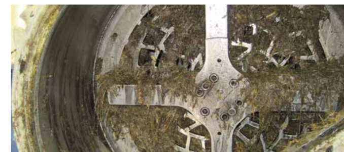
Le macérateur assure un broyage fiable des substrats et sépare les corps étrangers après le malaxage.
